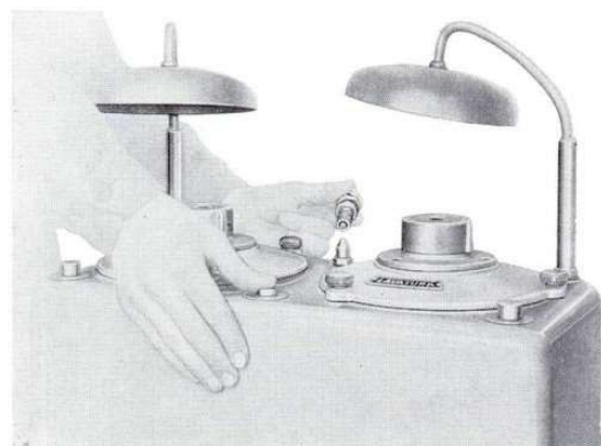
Sl. 9 — Sušenje prethodno peskarene i oprane svećice
