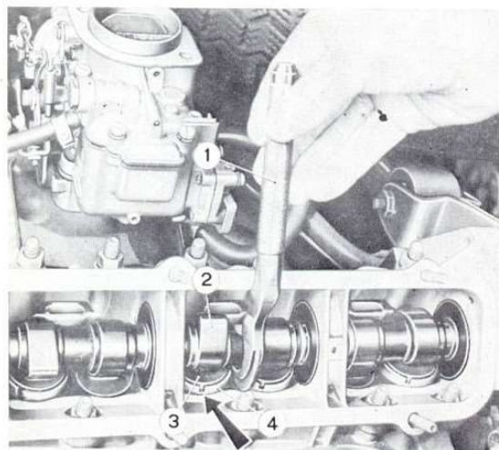
Sl. 120 — Primena alata A.60421 za podešavanje zazora između podizača ventila i brega na bregastoj osovini
