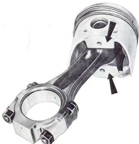
Sl. 91 — Sklop klipnjače i klipa
