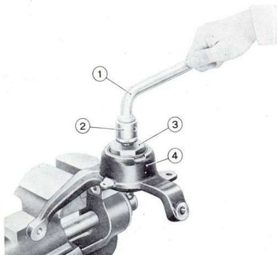
Sl. 34 — Odvijanje prstenaste navrtke ležaja iz nosača glavčine točka
