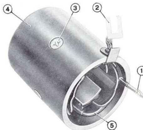
Sl. 17 — Karkasa elektropokretača komplet sa pobudnim namotajem i krajevima polova
