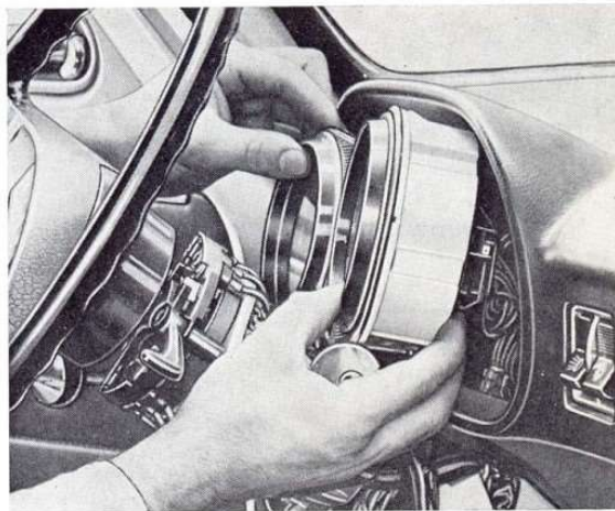
Sl. 7 — Izgrađivanje sklopa mernih instrumenata
