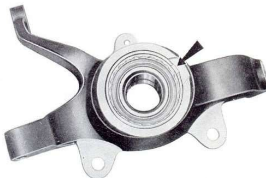
Sl. 28 — Pogled na nosač glavčine točka sa ležajem osiguranim pomoću prstenaste navrtke
