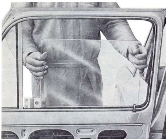
Sl. 46 — Izgrađivanje kliznog stakla zadnjih vrata
