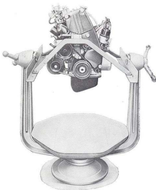
Sl. 9 i 10 — Izgled motora na obrtnom radnom stolu Ar. 22204; motor pričvršćen nosačima A 61001/14/15
