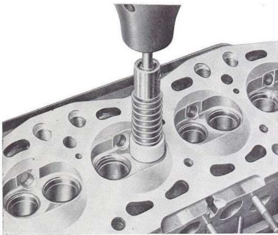
Sl. 59 — Brušenje sedišta izduvnog ventila na glavi cilindara pomoću konusnog brusnog kamena (45°) A.94093
