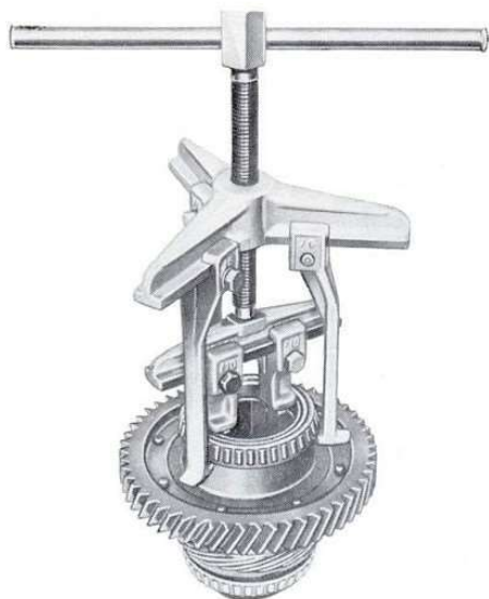
Sl. 45 — Izgrađivanje unutrašnjeg prstena ležaja diferencijala
