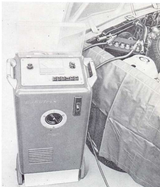
Sl. 32 — Punjenje akumulatora pomoću uređaja Ap. 5008
