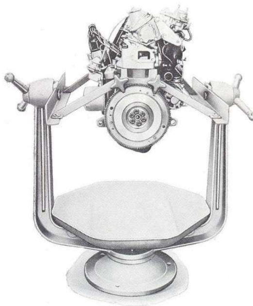
Sl. 9 i 10 — Izgled motora na obrtnom radnom stolu Ar. 22204; motor pričvršćen nosačima A 61001/14/15
