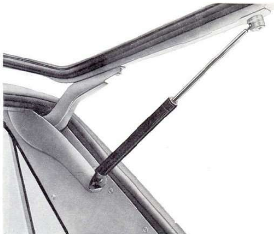
Sl. 58 — Pneumatski amortizer na petim vratima sa desne strane
