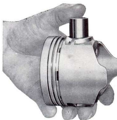
Sl. 86 — Pravilan spoj osovinice i klipa
