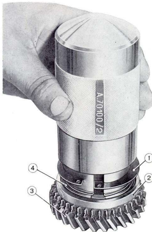
Sl. 19 — Ugrađivanje elastičnog prstena za pridržavanje sinhronizatora pomoću alata A. 70225
