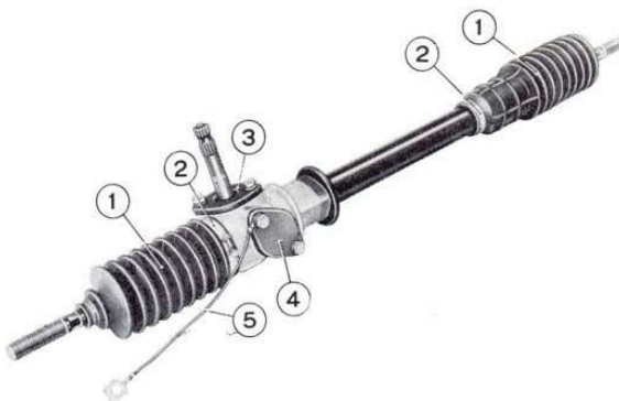
Sl. 9 — Sklop kućišta upravljača
