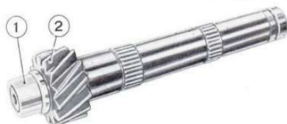
Sl. 15 — Izgled pomoćnog vratila menjača stepena prenosa
