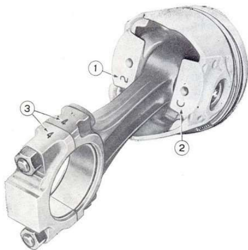
Sl. 85 — Sklop klipnjače i klipa
