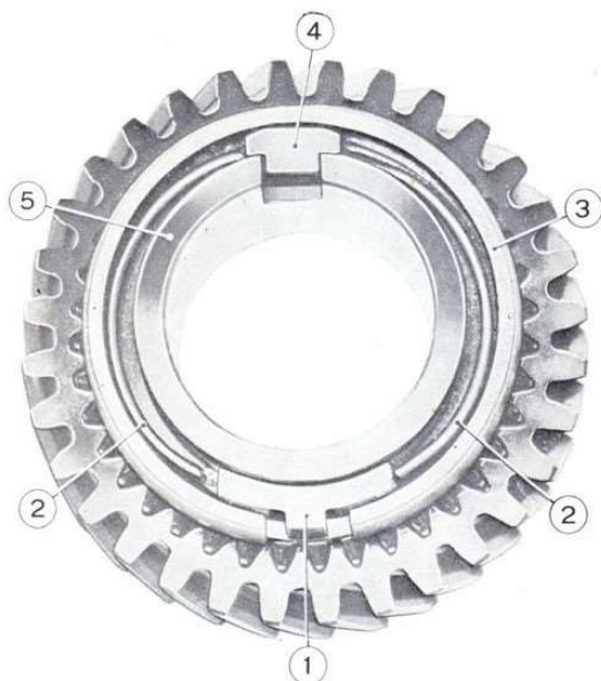
Sl. 14 — Sinhronizator na zupčanicu 3-eg stepena prenosa
