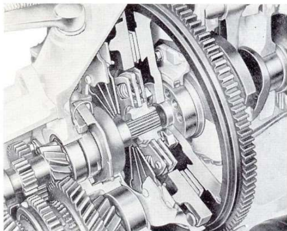
Sl. 7 — Presek sklopa spojke ugrađene na motor
