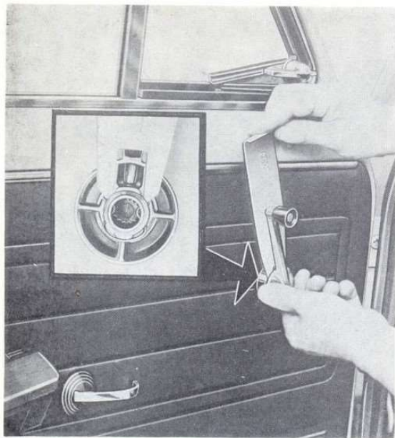
Sl. 33 — Izgrađivanje ručice za podizanje stakla pomoću alata A.78034
