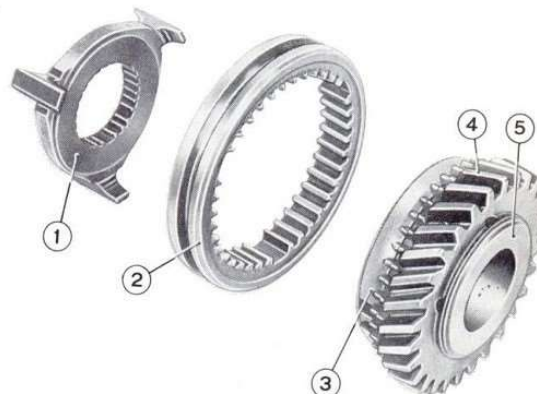
Sl. 17 — Pojedini obrtni delovi menjača stepena prenosa
