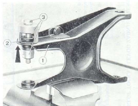
Sl. 99 — Vađenje elastične čaure iz oscilujućeg ramena, do rukavca točka
