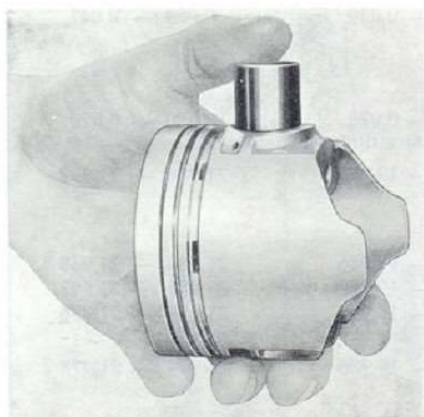
Sl. 27 — Način provere spoja klipa i osovinnice
