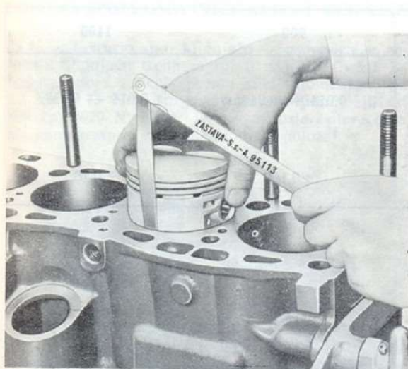
Sl. 29 — Kontrola zazora između klipa i cilindra pomoću kontrolnih listića A. 95113
