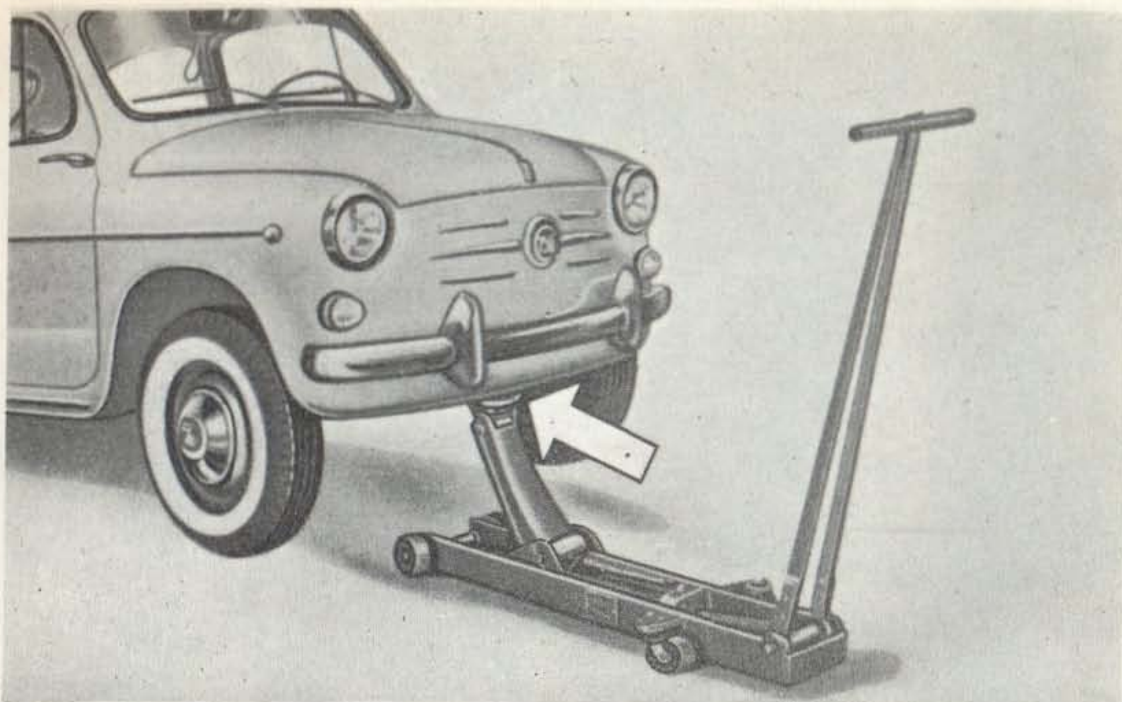
Sl. 24. — Podizanje prednjeg dela vozila pomoću hidraulične dizalice.
