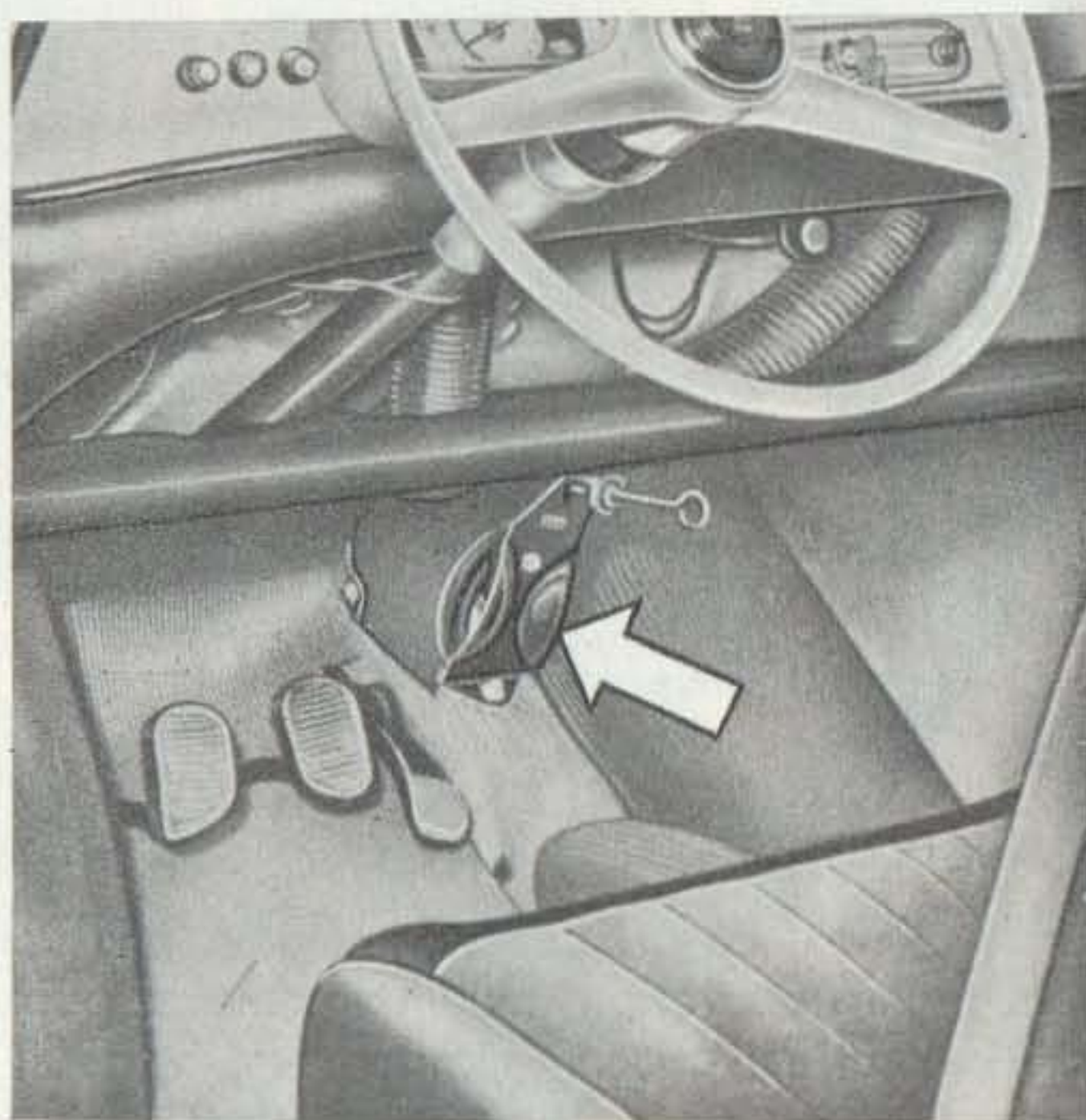
Sl. 20. — Otvori za ulaz toplog vazduha za zagrevanje unutrašnjosti vozila.
